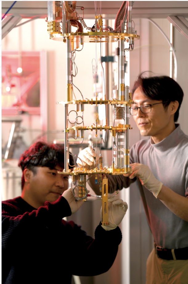
한국표준연구원 양자기술연구소에 마련된 니오븀 나노전기역학 소자 측정 시스템.
