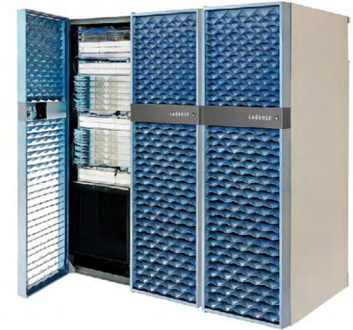
미국의 소프트웨어 기업인 케이던스 디자인 시스템즈 코리아(Cadence Design Systems, 이하 케이던스)가 반도체 설계 특화 장비인 '케이던스 팔라디움 제트원(Cadence Palladium Z1)'을 KAIST에 기증했다. 케이던스는 1983년에 설립된 미국의 다국적 기술 및 컴퓨팅 소프트웨어 기업으로, 반도체 제품 설계를 위한 소프트웨어 및 하드웨어를 제작하는 곳이다. 현재 삼성전자 파운드리 사업부의 EDA 공식 파트너로서 국내 반도체 기업의 칩 설계를 위한 소프트웨어와 하드웨어를 공급하고 있다. 팔라디움 제트원은 반도체 설계 검증에 위한 초고성능 에뮬레이터 장비로, 하드웨어-소프트웨어 검증 및 디버깅 작업을 1개의 랙 당 5.76억 게이트까지 대용량으로 구현 가능하다.
