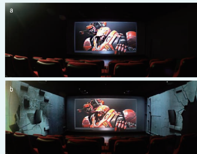
(그림 1)스크린 엑스 기술은 일반적인 영화관(a) 몰입화된 극장으로(b) 변화시킨다. 이때, 멀티 프로젝션 기술을 좌, 우 양쪽 벽면에 적용하여 극장의 삼 면을 스크린처럼 활용한다. 극장의 구조를 변화시키지 않고 저가의 소수 프로젝터만을 사용하는 특징을 가진다.
