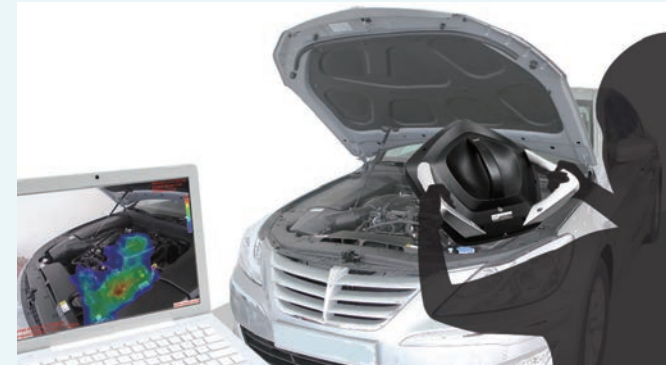
휴대용 음향카메라를 이용해 소음이 발생하는 위치를 찾는 모습
