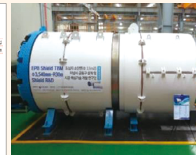
그림 2. TBM 급곡(30m) 장치 시제품
