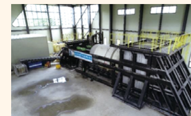
그림 4. 소단면 TBM 선단부 굴진 시험 장비
