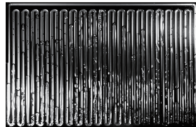
〈그림 2〉 방열장치 내부 작동 유체의 진동 운동
