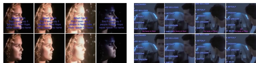
그림 2. 제안된 방법은 임의 비디오 시퀀스에 심각한 밝기 변화가 있거나(왼쪽), 비디오 자체의 텍스트가 재생되는 경우에도(오른쪽) 덧입혀진 자막을 인식, 제거한 후, 자연스럽게 채워넣는다
