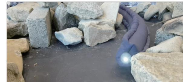
그림 3. 건물 붕괴와 같은 재난모사 환경에서 자라나는 로봇 성능시연 사진
