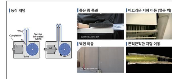
그림 1. 식물의 줄기를 모방한 자라나는 로봇의 동작 개념 및 특징
