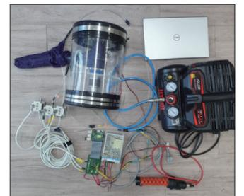
그림 2. 건축시설물 내 협소공간 모니터링 및 유지보수 위한 자라나는 로봇 시제품
