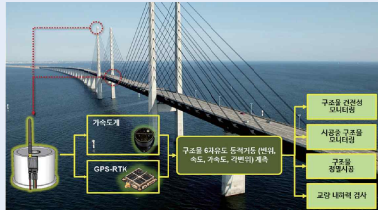
그림 1. 제안된 구조물 6자유도 동적거동 정밀제어 시스템 개요
